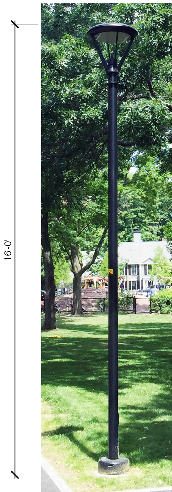
2 Pedestrian Light Pole - (LP - P) Scale: 1/2" = 1'-0"
